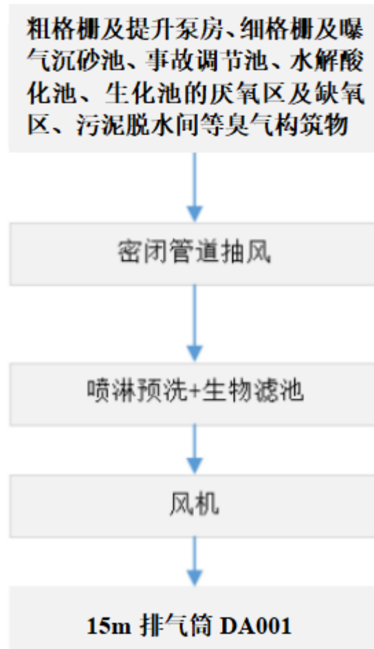
图 6.3.1-1 废气处理工艺流程图
