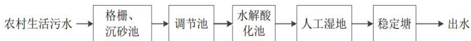
图 20 水解酸化+人工湿地+稳定塘工艺流程图
