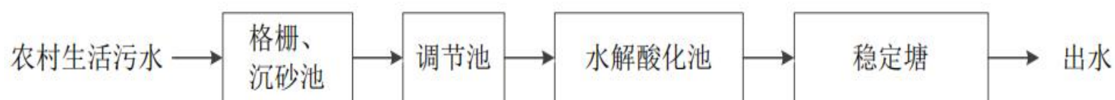
图 19 水解酸化+稳定塘工艺流程图
