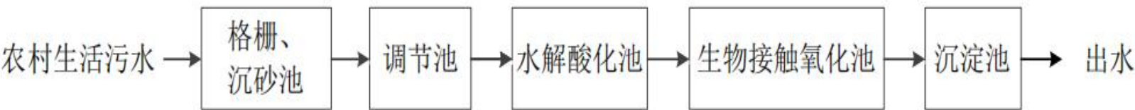
图 13 水解酸化+生物接触氧化工艺流程图
